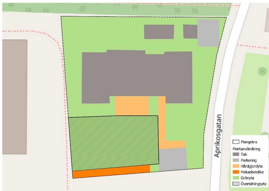
Figur 21 Föreslagna dagvatten- och skyfallsåtgärder inom planområdet för alternativ 2. *Översilningsytan syftar på att fördröja och rena dagvatten samt att ha översvänningsfunktion för att hantera skyfall.
